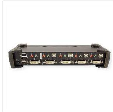
**DVI-KVMP-Switch mit 4 Ports, USB 2.0-Unterstützung und 2.1-Kanal-Surround-Sound-Übertragung. Eine USB-Konsole steuert vier Computer und zwei weitere USB-Geräte.**
