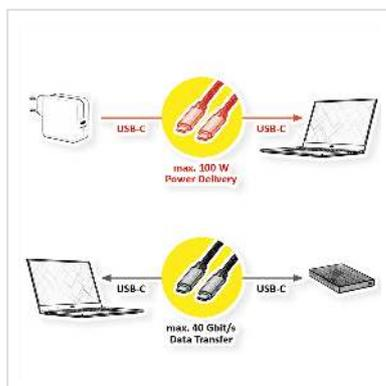
**USB 4 Gen 3x2 Kabel in hoher Qualität mit dem reversiblen USB-C Stecker an beiden Enden für Datentransferraten von bis zu 40 Gbit/s und USB Power Delivery bis 20V / 5A.**
