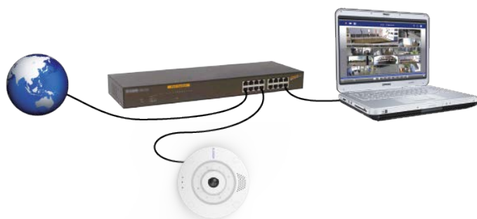
Abb. 16: Stromversorgung über PoE-Switch gemäß PoE Plus (802.3at-2009).
