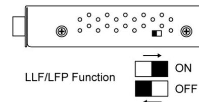
Link Loss Forwarding (LLF) / Link Fault Pass Through (LFP) est une fonction permettant de transférer le message en cas de défaillance d'une connexion par fibre optique. Avec Link Fault Pass Through, les administrateurs système sont en mesure de détecter une défaillance de liaison dans un court laps de temps et de minimiser la perte causée par ce problème.
